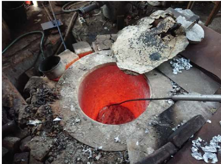
Gambar 3. 8 Proses Peleburan Bahan
