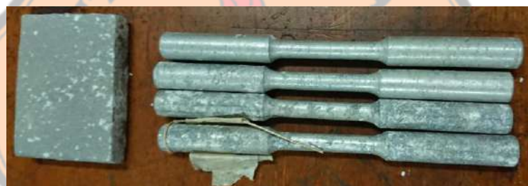
Gambar 4.7 Partikel garam dan produk korosi yang menempel pada spesimen aluminium kondisi awal setelah mengalami dua bulan perlakuan korosi.
