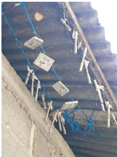
Gambar 4.6 Benda uji digantung dibawah atap rumah ( outdoor ).
