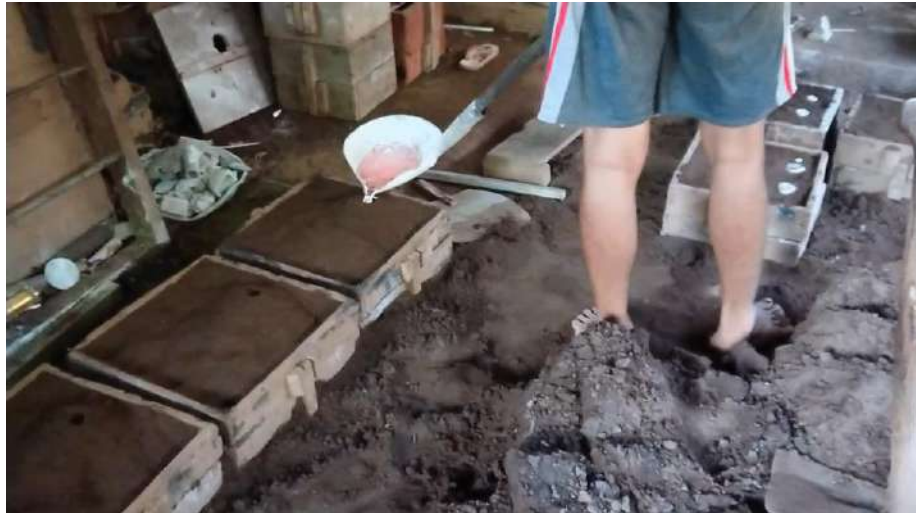
Gambar 3. 9 Penuangan Logam Aluminium
