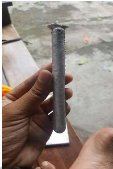
Gambar 3.10 Hasil cetakan yang baru dilepas dari cetakan
